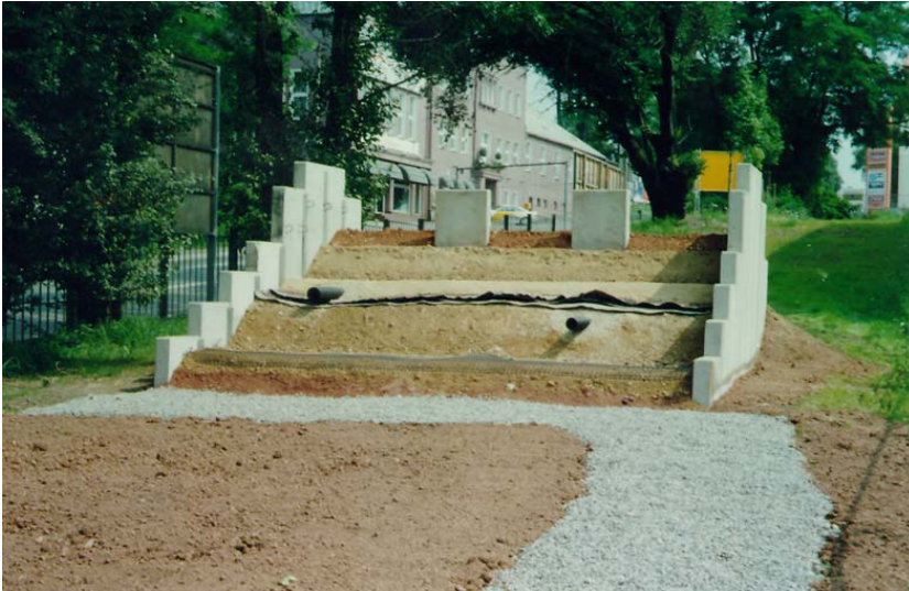
Aufbau des Drain- und Dichtsystems (Modell)
