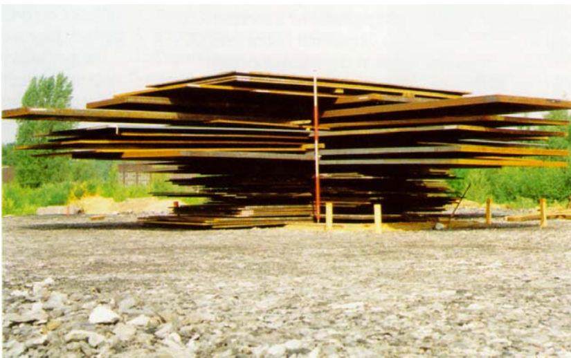
Simulation von Bauwerkslasten auf dem Testfeld
